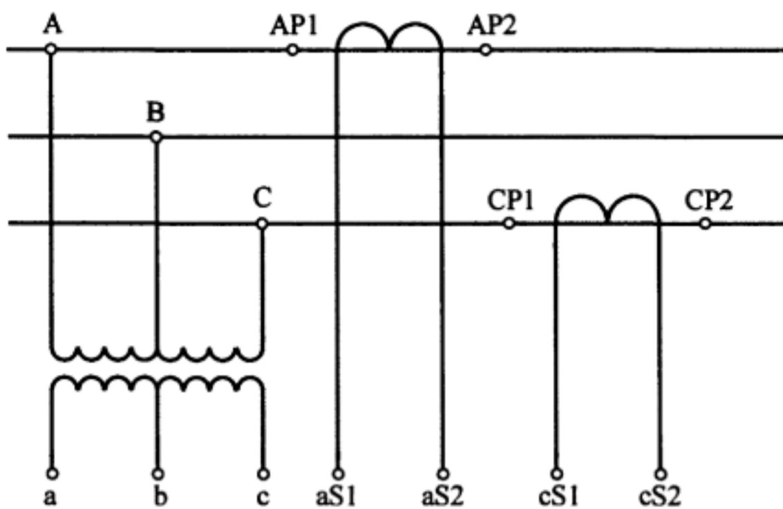
图1 由三相V联结电压互感器和两台电流互感器组成的三相组合互感器端子标志
