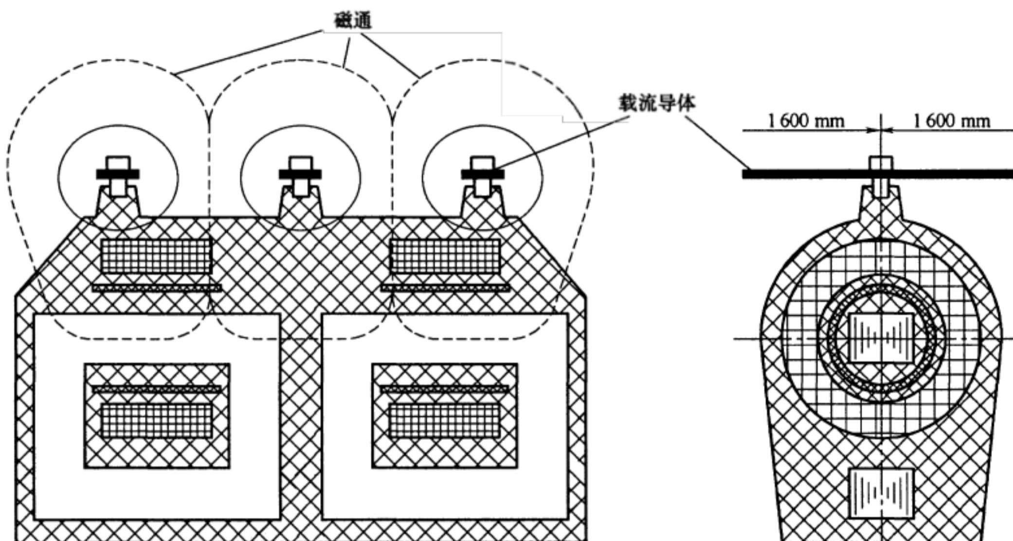
图A.1 影响三相V联结电压互感器的载流导体及磁场
