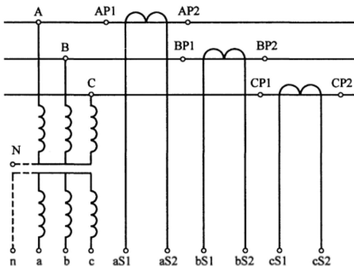
图2 由三相Y联结电压互感器和三台电流互感器组成的三相组合互感器端子标志
