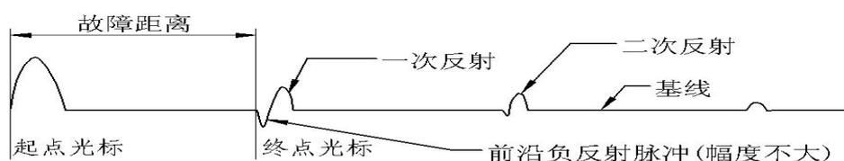
波形特点：发射脉冲为正脉冲波形，一次反射为负脉冲波形，二次反射为正脉冲波形，三次反射又为负脉冲波形，依次类推。
