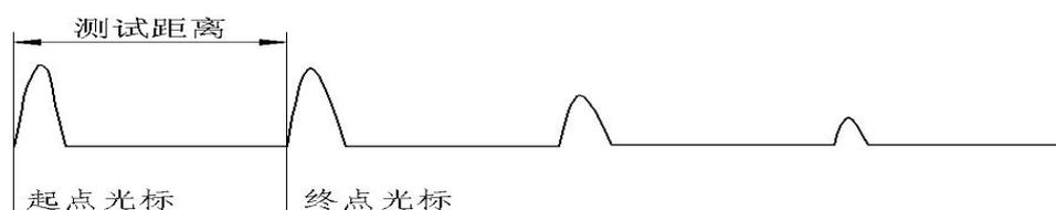
图 23 冲闪法测试纯短路故障波形
