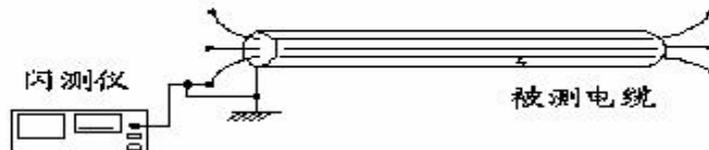
图 11 低压脉冲测试接线图
