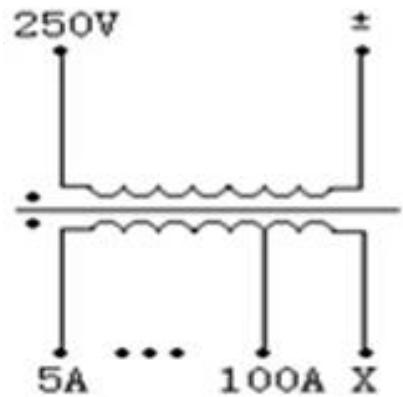
2、电流互感器结构原理图
