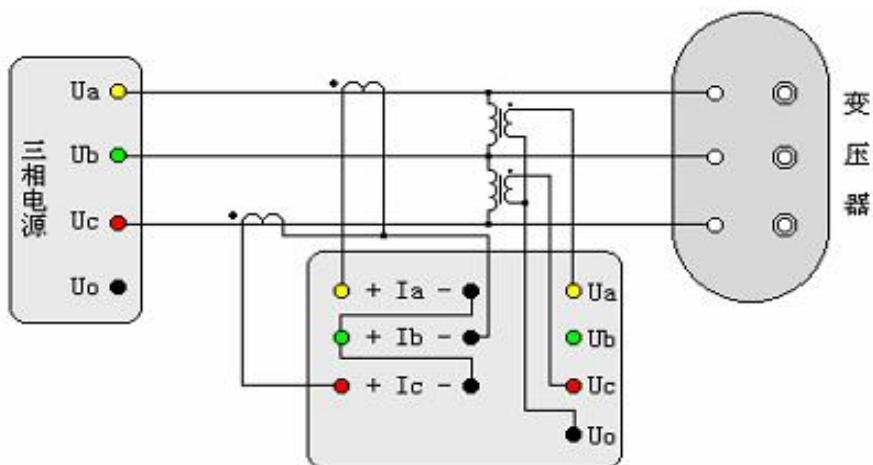
图三十一 三相三线经 PT 和 CT 测量空载损耗
