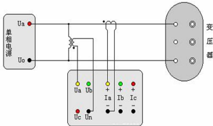
图二十四 单相电源外接 PT 和 CT 测量三相变压器空载损
