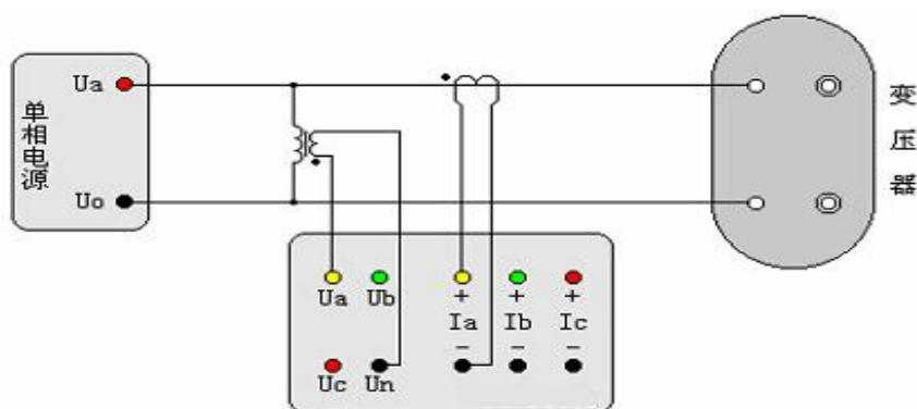
图十八、外接 PT 和 CT 对单相变压器空载损耗的测量
