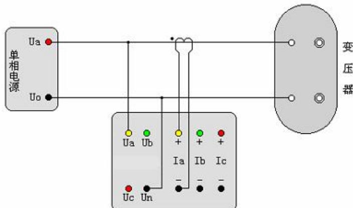
图十九、外接 CT 对单相变压器空载损耗的测量
