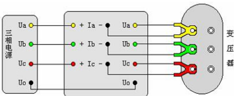
图二十七 三相四线直接接入测量
